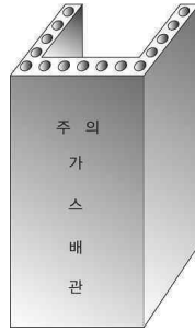
그림 2.5.7.3.1(2)③ “ㄷ” 형태의 철근콘크리트재 방호구조물에 의한 방호조치
