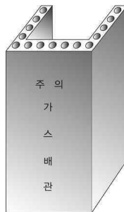
그림 2.5.7.3.1(2)③ “C” 형태의 철근콘크리트제 방호구조물에 의한 방호조치
